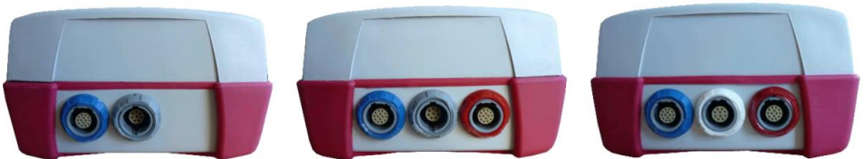
Рисунок 4: Панель разъемов портативных устройств (слева направо: Senti, Sentiero, Sentiero Advanced)
