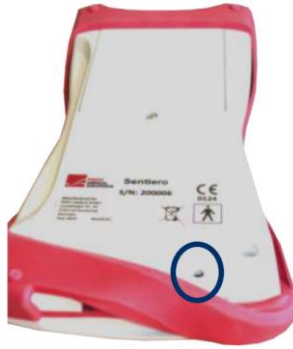
Рисунок 3: Кнопка reset на портативном устройстве.
